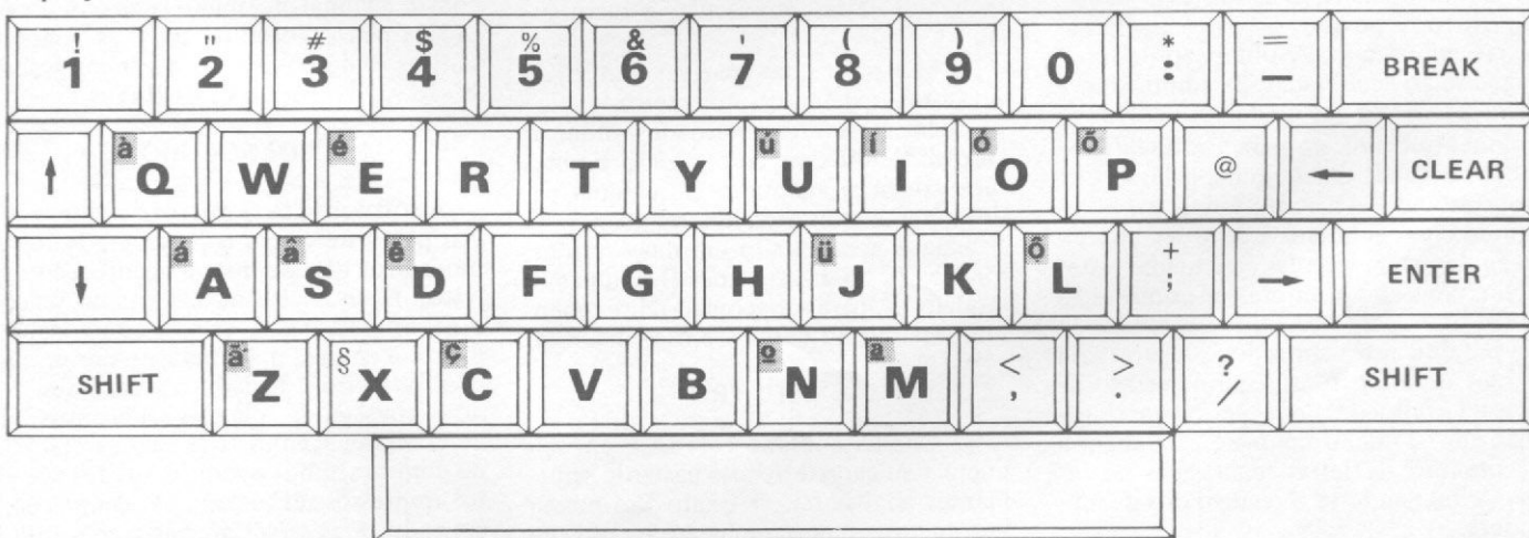
Disposição das letras acentuadas no teclado de micros da linha TRS-80 (CP-500; DGT-1000) para o sistema Multprint.
